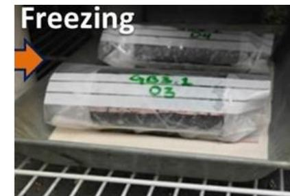
Eprouvette dans sac avec 10cl d'eau
