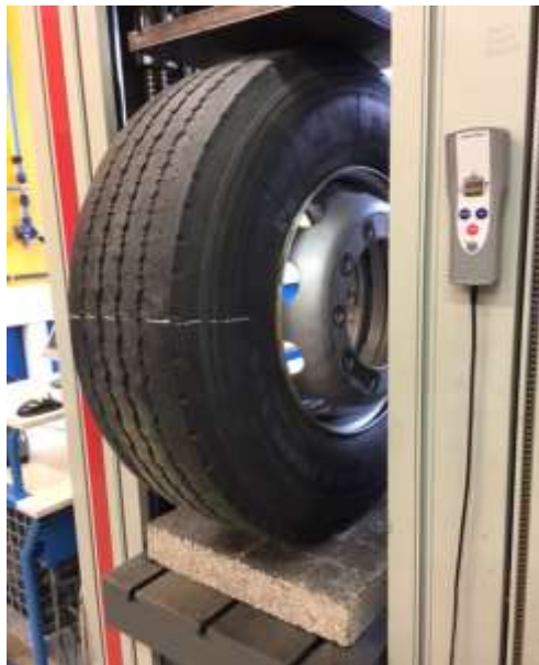
Figure 6 : Montage du pneu Michelin sur la presse Zwick
