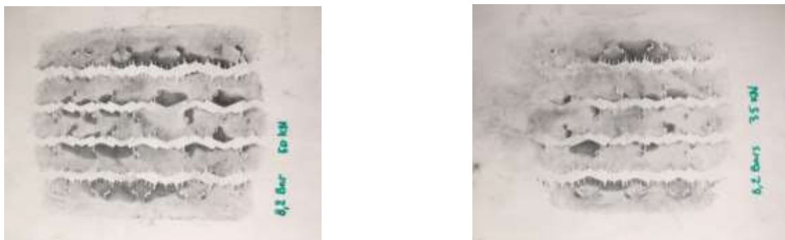
Figure 8 : Empreintes du pneu suite à un chargement sous presse reportées au graphite sur papier (50KN à gauche et 35 KN à droite)
