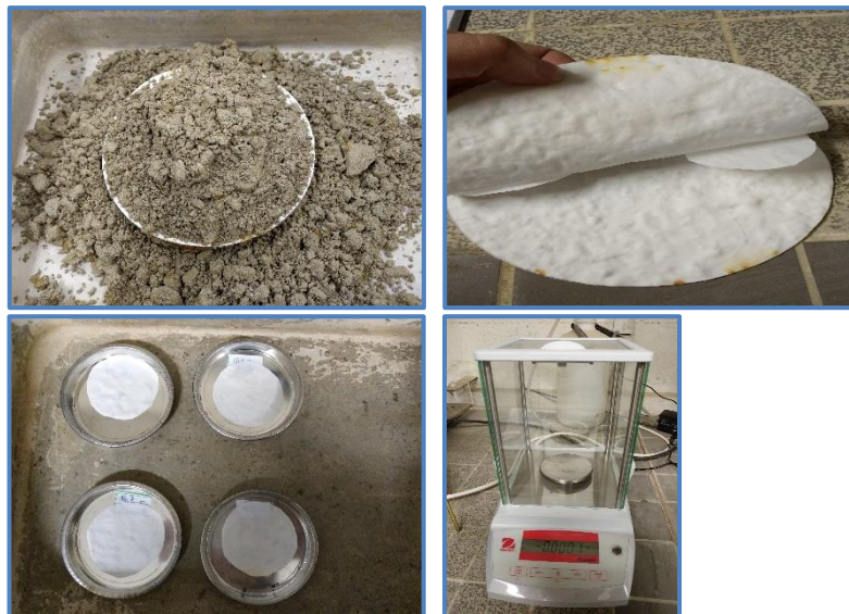
Figure 7 : Dispositifs utilisés pour la réalisation des échantillons et l'introduction de papiers filtres et la balance
