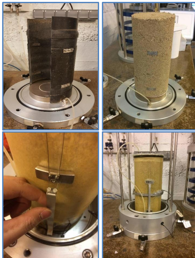
Figure 14 : Dispositifs utilisés pour la fixation des capteurs de déplacement avec vis
