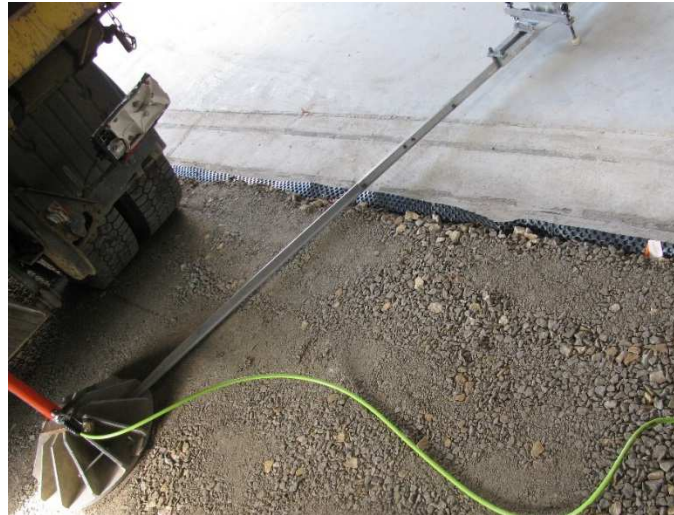
Figure 3 : Essai à Poutre de Benkelman (photo : GC2D)
