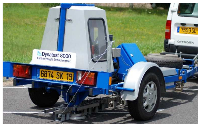
Figure 5 : FWD (photo : Laboratoire GC2D)
