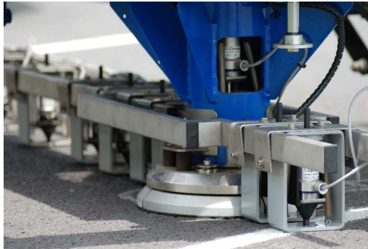
Figure 15 : Plaque de chargement et rampe de géophone (photo : GC2D)
