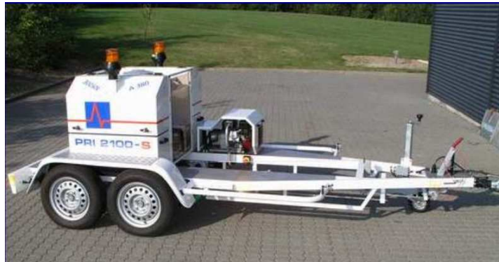
Figure 11 : PRIMAX 2100 HWD (photo : [BRO14])
