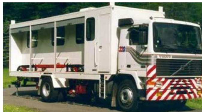
Figure 7 : Curviamètre (photo : STAC)
