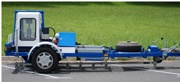
Figure 10 : Dynatest 8000 (photo : Laboratoire GC2D)
