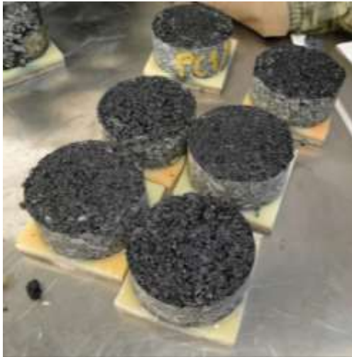
Figure 19 Mode de rupture : éprouvettes torsion mécanique, sixième ligne du plan d'expériences
