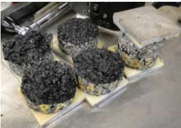
Figure 18 Mode de rupture : éprouvettes torsion mécanique, deuxième ligne du plan d'expériences
