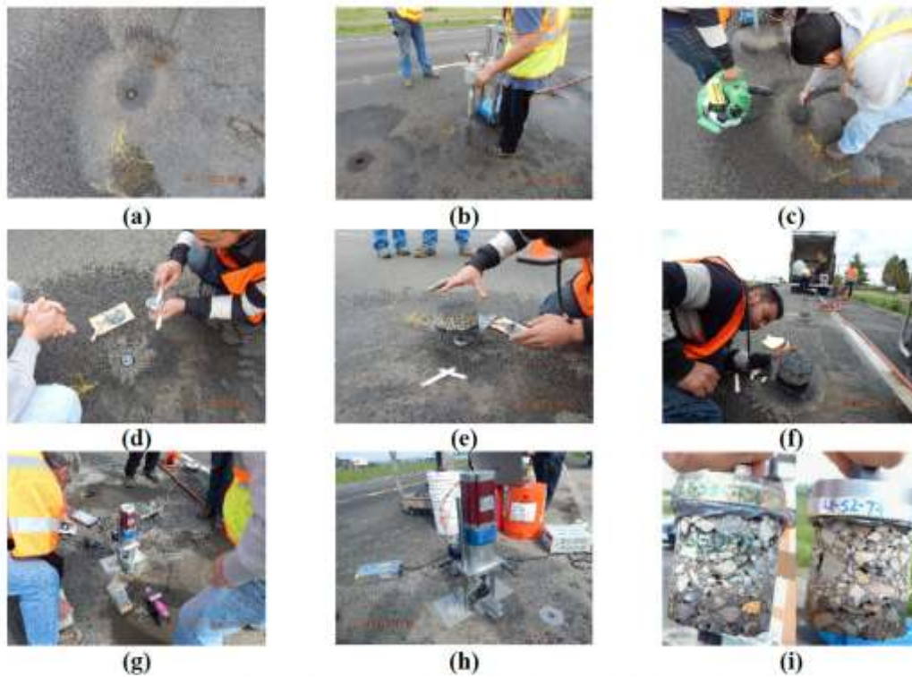
Figure 9 Procédure générale suivie pour l'essai via le dispositif OFTT
