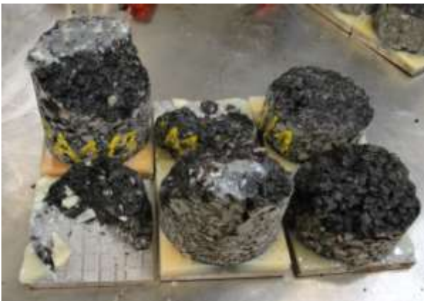
Figure 17 Mode de rupture : éprouvettes torsion mécanique, première ligne du plan d'expériences
