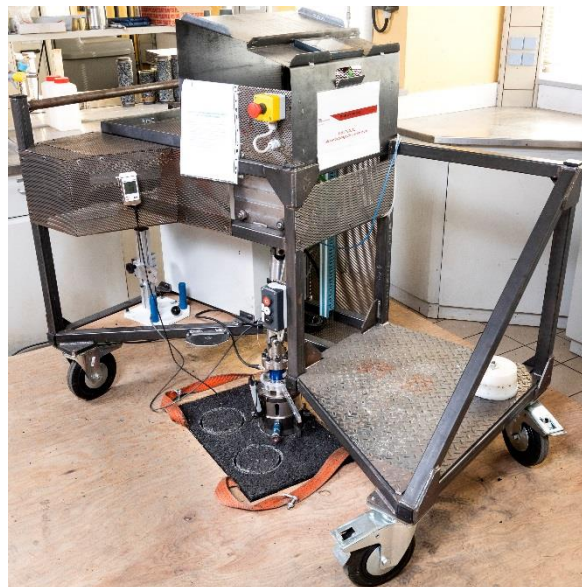
Figure 9. Prototype d'essai de torsion en laboratoire et sur site
