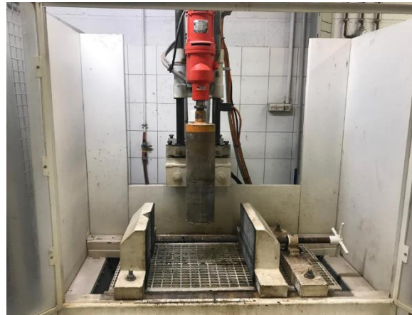
Figure 8. Carottier de laboratoire
