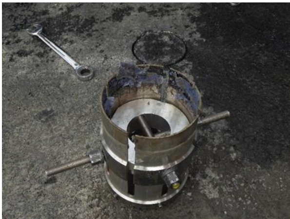
Figure 23 & 24. Casque après essai et empreinte après carottage
