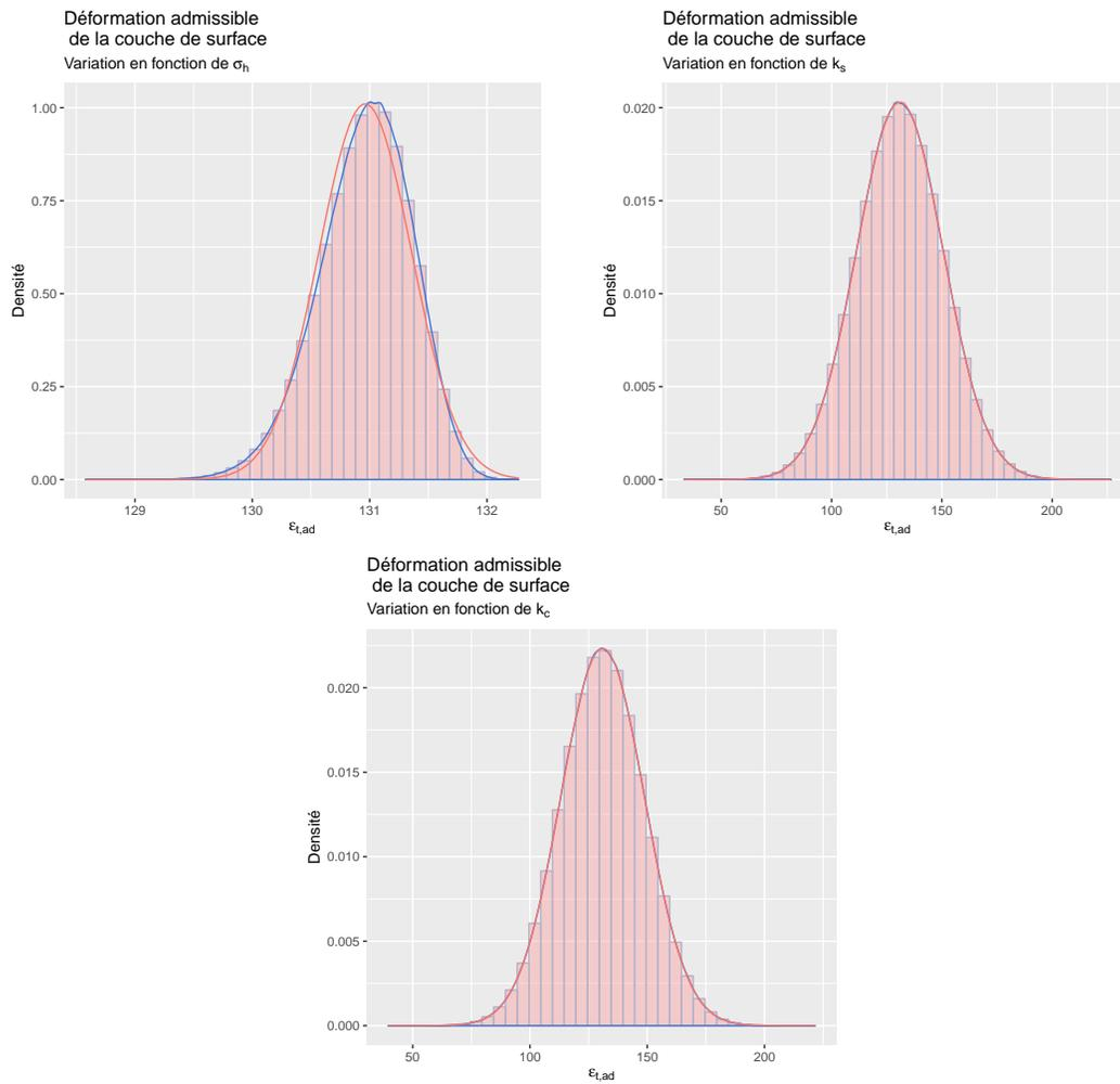
**FIGURE 4.2** – Distribution de la déformation admissible du sol support en fonction des variations de  $\sigma_{h, BB}$  (en haut à gauche), de  $k_s$  (en haut à droite) et de  $k_c$  (en bas) pour la couche de surface.
