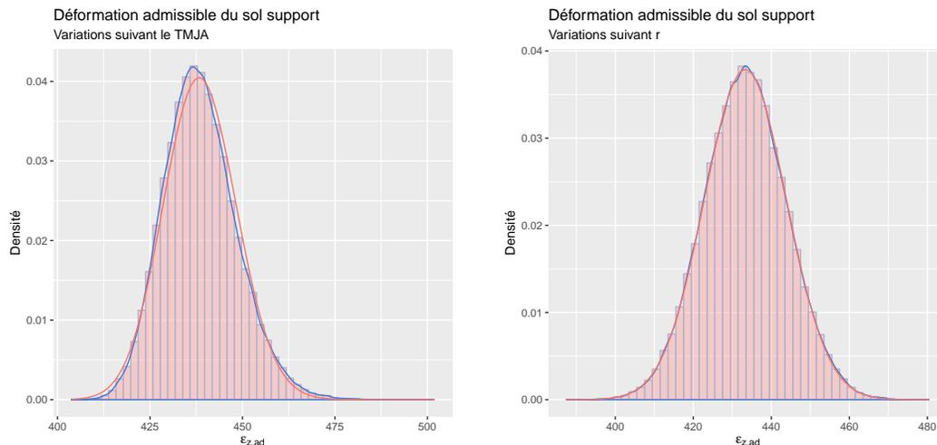
**FIGURE 4.1** – Distribution de la déformation admissible du sol support en fonction des variations du TMJA (gauche) et de  $r$  (droite).
