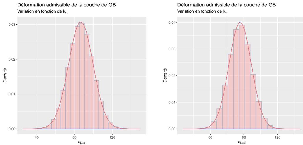
**FIGURE 4.4** – Distribution de la déformation admissible de la GB en fonction des variations de  $k_s$  (gauche) et de  $k_c$  (droite).
