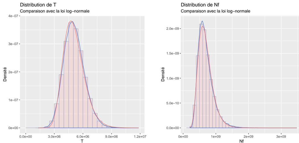
**FIGURE 2.1** – Distribution de  $T$  (gauche) et  $Nf$  (droite), avec ajout de la distribution d'une loi log-normale (en rouge).
