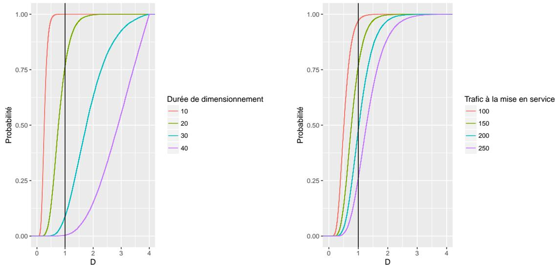
**FIGURE 2.3** – Fonction de répartition de  $D$  en fonction de la durée de vie initiale pour un trafic initial de 150 (gauche), et en fonction du trafic initial pour une durée de dimensionnement de 20 ans (droite).
