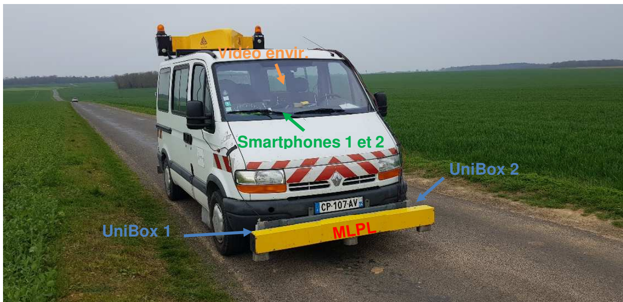
Photo 5 - Véhicule instrumenté (appareils de référence MLPL et UniBox, smartphones, vidéo)
