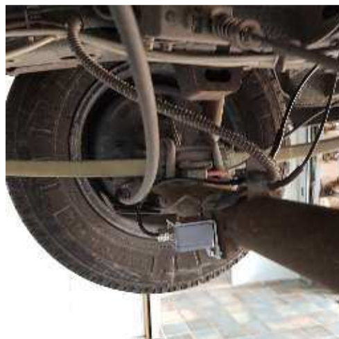
Photo 2 - Capteur installé solidaire de l'axe de roue
