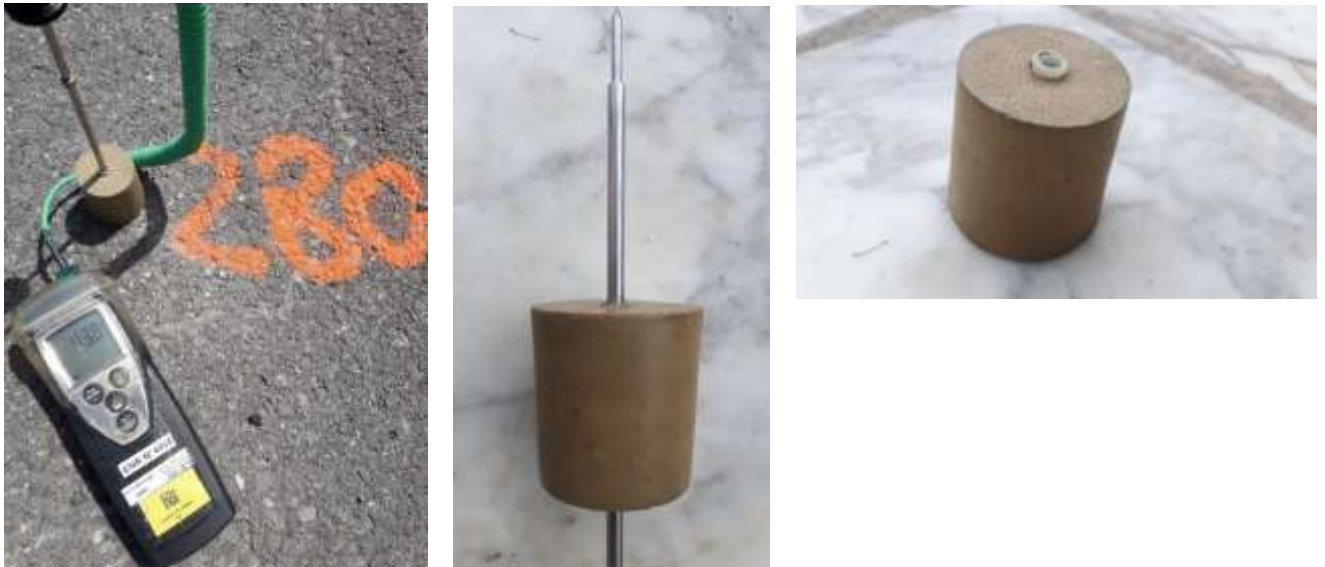
Figures 13-14-15 : dispositif de mesure de la température proposé
