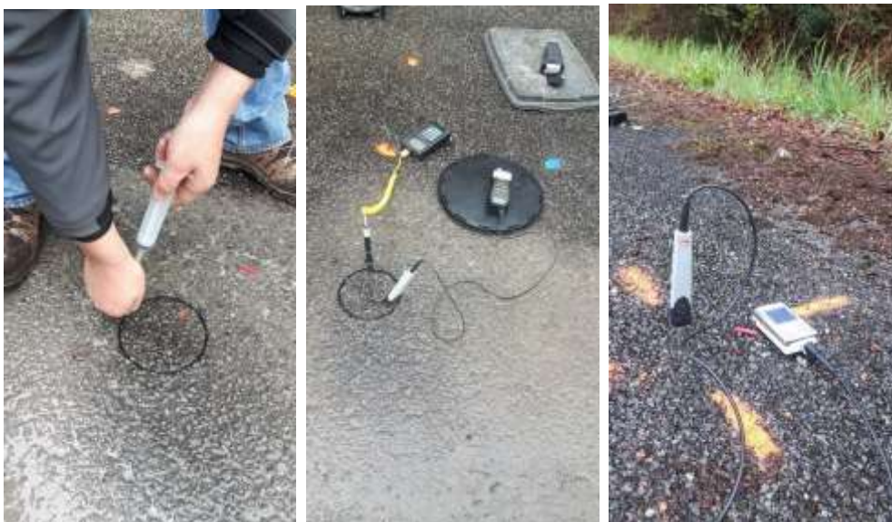
Figure 1 : Pré-carottage et prises de température dans la chaussée
