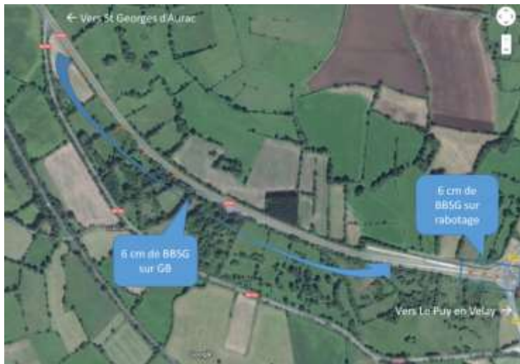
Figure 9 : implantation du chantier de la RN102
