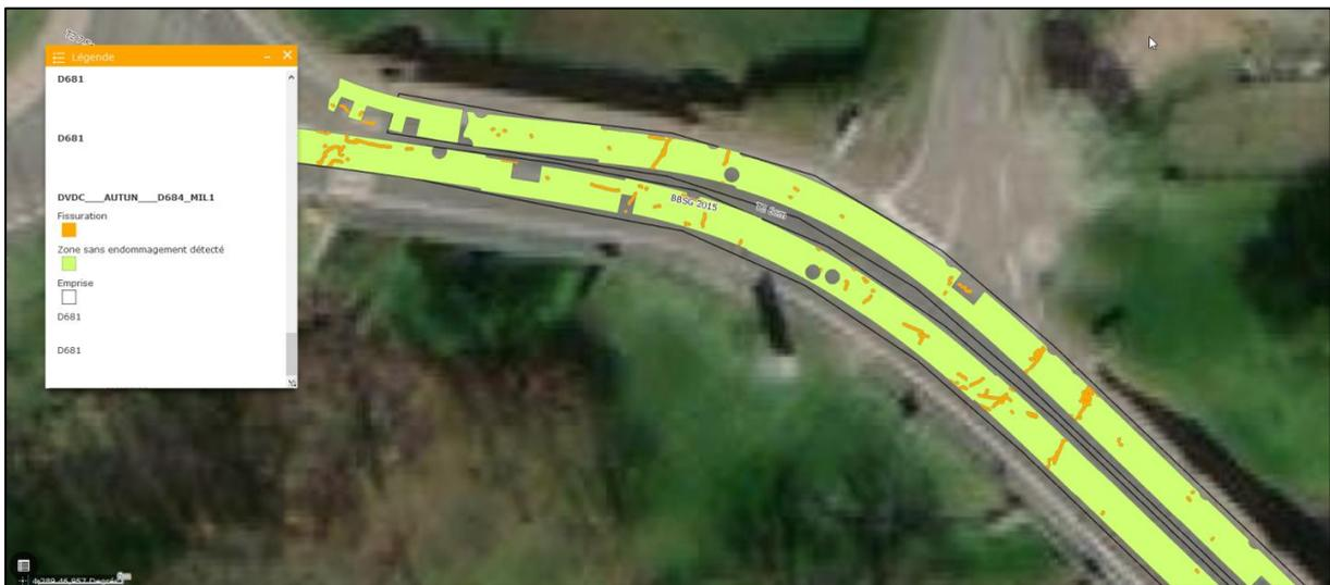
Figure 6. Projection des recensements de fissures et de zones sans dégradation issus du passage de l'Aigle 3D sur la RD681
