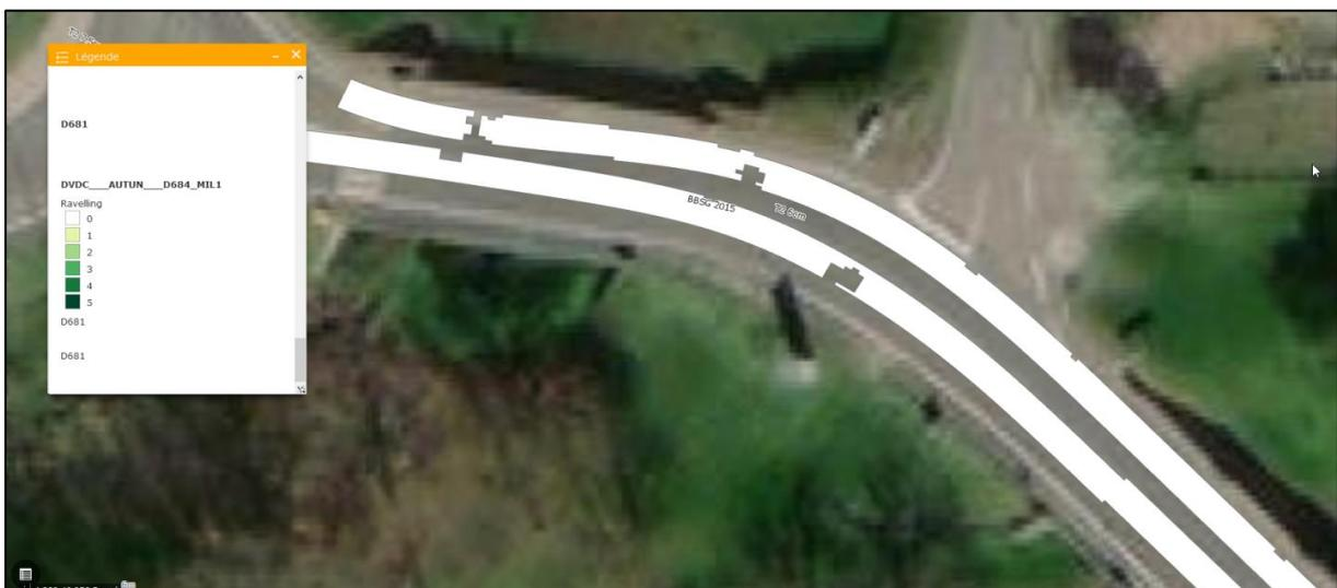
Figure 4. Projection des recensements de raveling issus du passage de l'Aigle 3D sur la RD681
