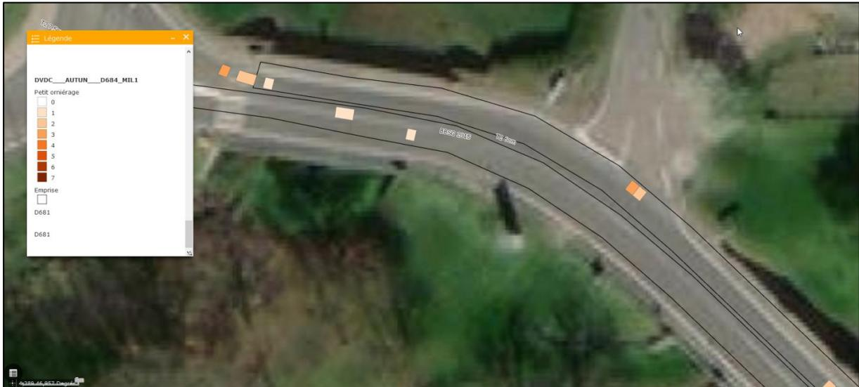
Figure 3. Projection des recensements de petits orniérages issus du passage de l'Aigle 3D sur la RD681
