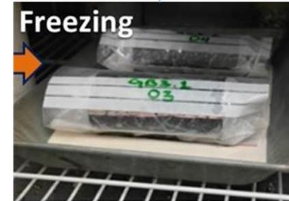
Eprouvette dans sac avec 10cl d'eau
