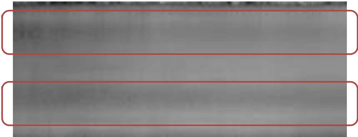
*Représentation visuelle de la nappe 3D : la hauteur est ici convertie en niveau de gris (256 valeurs possibles recouvrent 60 mm, centrées sur l'altitude moyenne de 10 m, et les éventuelles valeurs hors plage sont transparentes). La résolution est de 5 cm. On constate que les bandes de roulement sont clairement visibles.*
